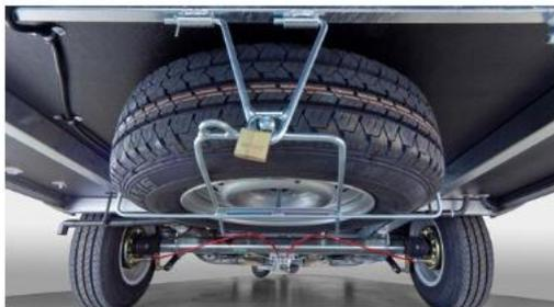
Roue de secours sur jante alliage léger avec support sous châssis, verrouillable
